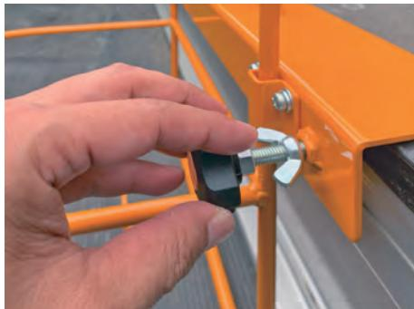
内側の蝶ネジを締めてガスボンベホルダー本体を荷台にしっかりと固定します。
