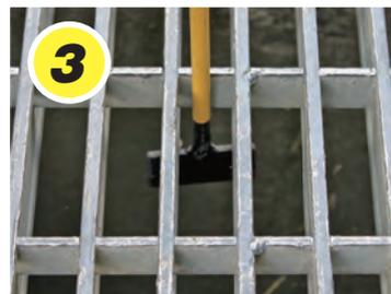
3 下部を側溝蓋の隙間に差し込んだ後、T字部分が引っかかるように角度を調整します。
